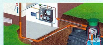
Exemple de kit : cuve à enterrer, couvercle, accessoires (pompe électrique, filtres...).
